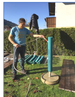
Reinigung der Filterstrümpfe
